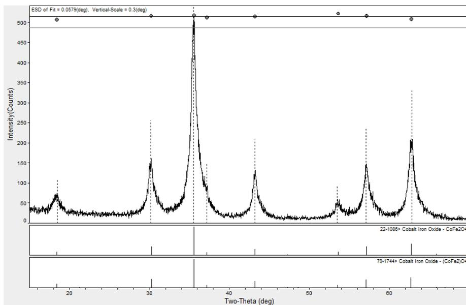
Fig. 2. XRD of  $\text{CoFe}_2\text{O}_4$
